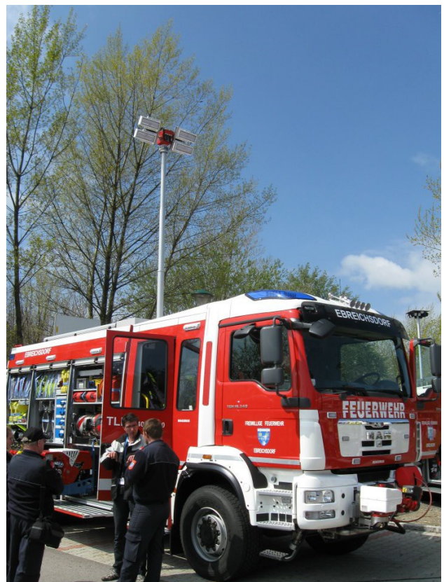
Ugradnja na vozila uz direktno napajanje, bez potrebe za agregatom
